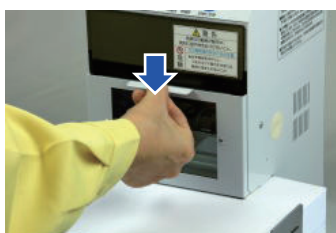
カバーをおろす (カバーをおろさないと穿孔しない安全設計)
