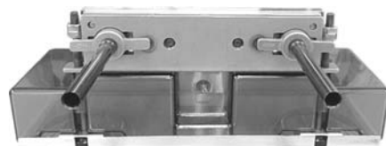
カス箱の前面を下にして置いた状態
